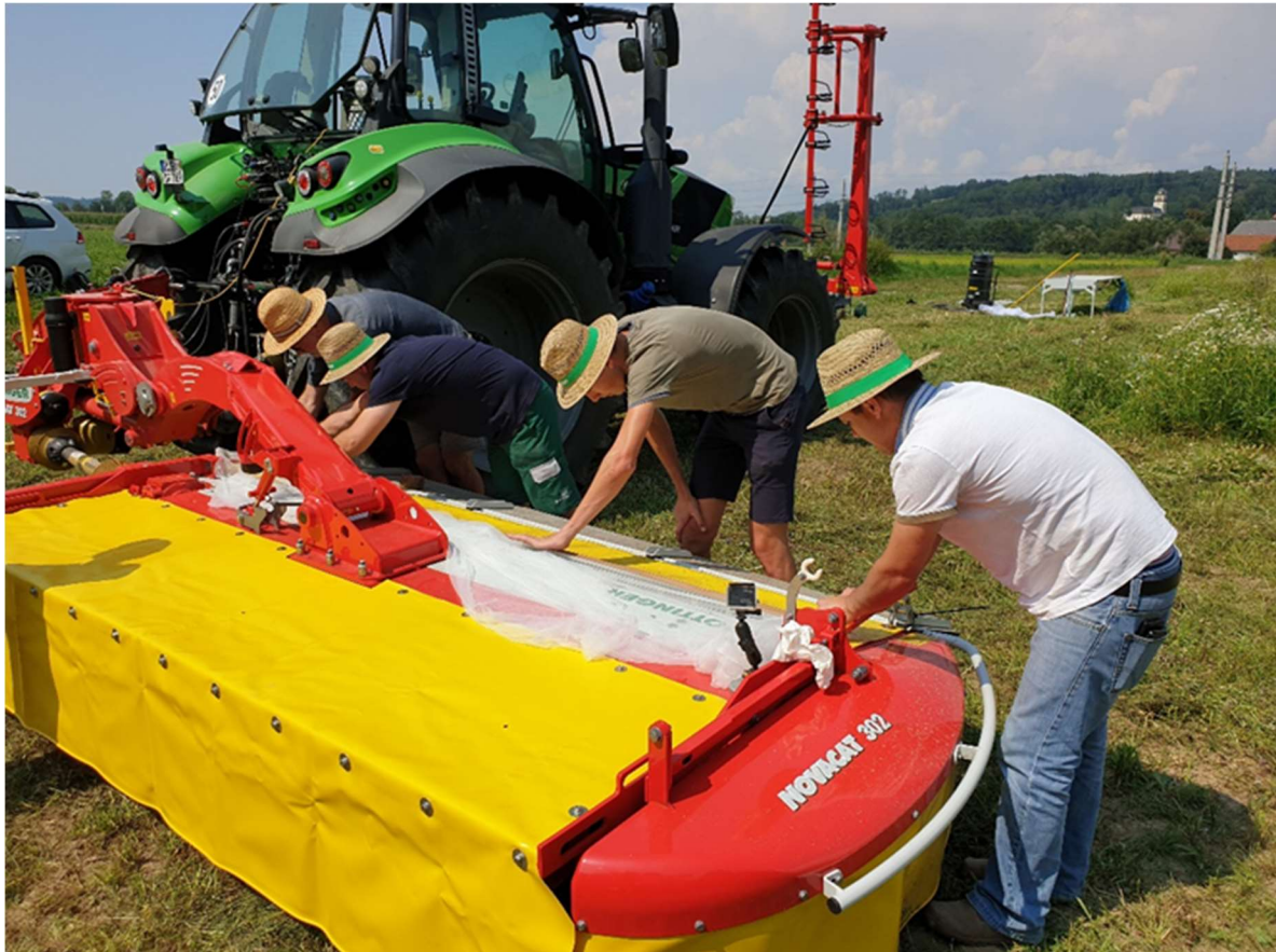
Abbildung 10: Öffnungen in der Mähwerkskonstruktion als mögliche Schutzvorrichtung zum Entweichen von Insekten.
