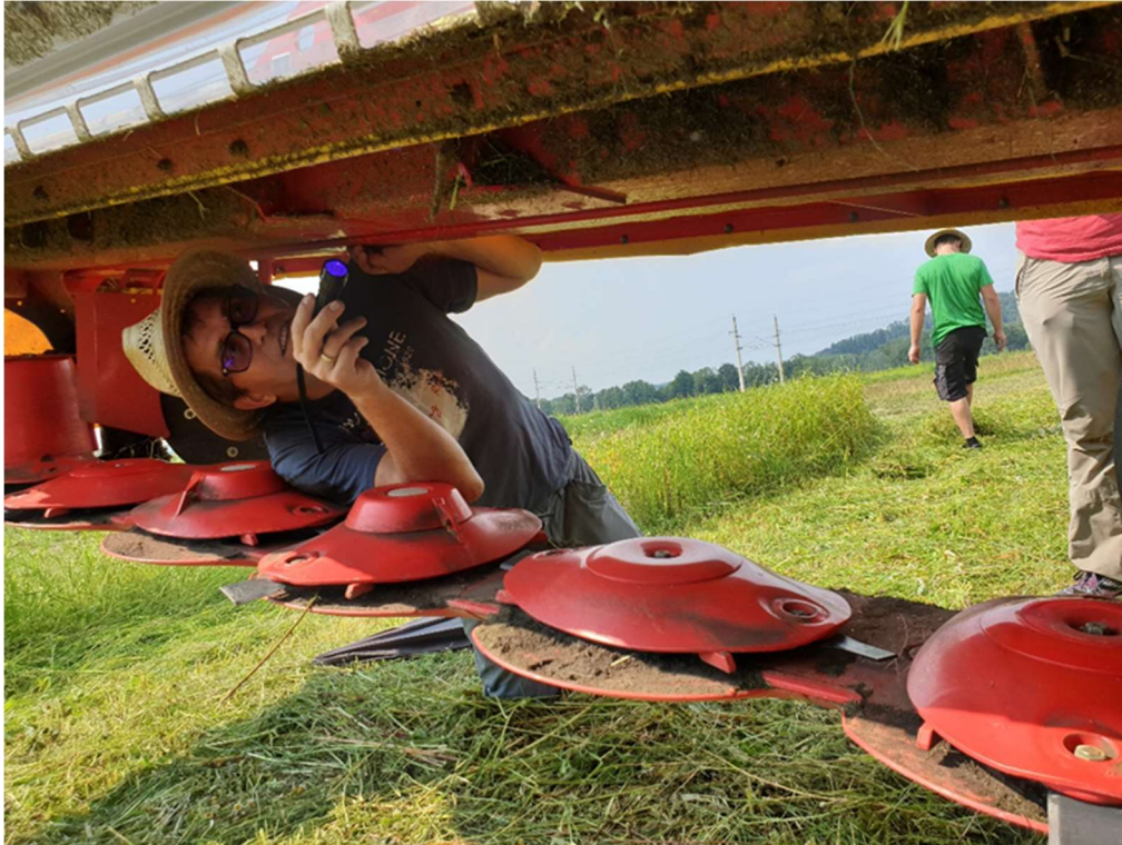
Abbildung 12: Josef Mayr (AGES) sucht den potentiellen Schädigungsort im Mähwerk mittels UV-Lampe – Suche nach Rückständen von fluoreszierendem Pulver.
