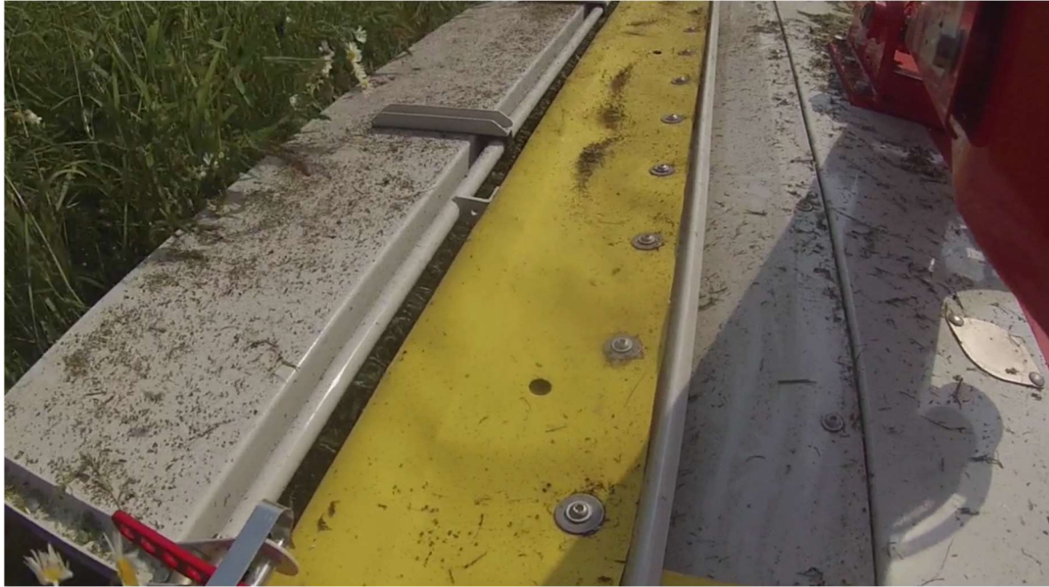
Abbildung 31: Screenshot einer Videoaufnahme beim Vorversuch in Grieskirchen. In dem Pflanzenbestand, reich an Ackerbeikräutern und -gräsern (Hirsen, Kamillen etc.), schien das Abweiserblech (links) seinen Zweck zu erfüllen und Insekten über das Mähwerk zu leiten.
